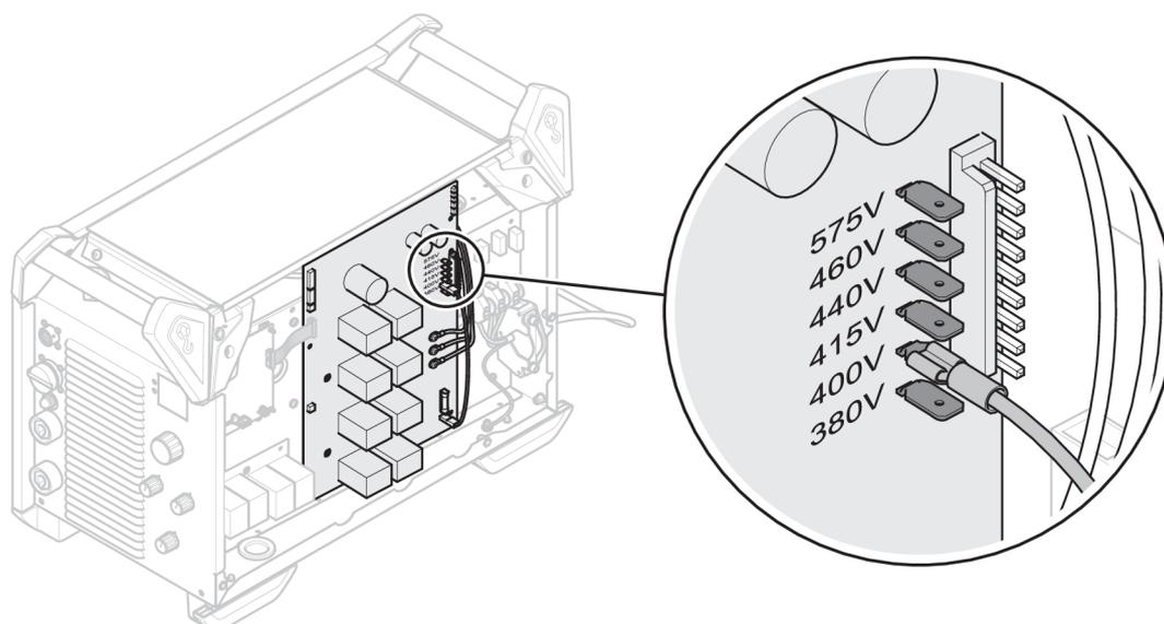
Le générateur Warrior 500i CC/CV (0465 350 881) pour les É.U. est connecté par défaut en usine à 460 V Le générateur Warrior 500i CC/CV (0465 350 887) pour le Canada est connecté par défaut en usine à 575 V
