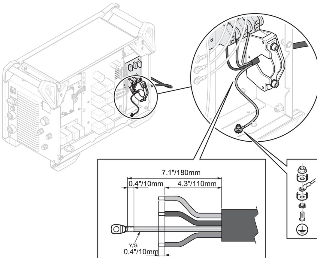
Il faut installer un câble d'alimentation. Il est important de relier la plaque inférieure à la terre de manière adéquate. Consultez le schéma ci-dessus pour connaître l'ordre dans lequel les rondelles, écrous et vis doivent être disposés.
